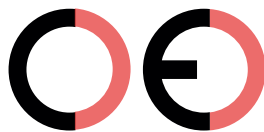
Virheellinen CE-merkki (liian kaukana)
