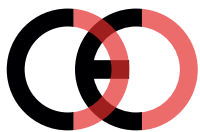
Virheellinen CE-merkki (liian lähellä)
