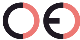
Virheellinen CE-merkki (liian kaukana)
