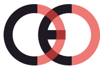
Virheellinen CE-merkki (liian lähellä)
