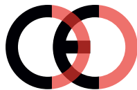
Falsche CE-Kennzeichnung (zu dicht)
