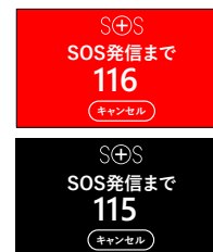
カウントダウン中、ドライブレコーダーの画面は赤と黒の背景が交互に切り替わります
